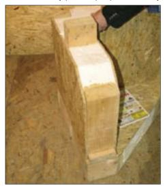
этими слоями заполняется жестким пенополистиролом толщиной 100—180 мм, играющим роль основного утеплителя. Склеивание плит OSB со слоем пенополистирола осуществляется под давлением, с использованием полиуретановых клеев, о вредности которых уже было сказано выше.
